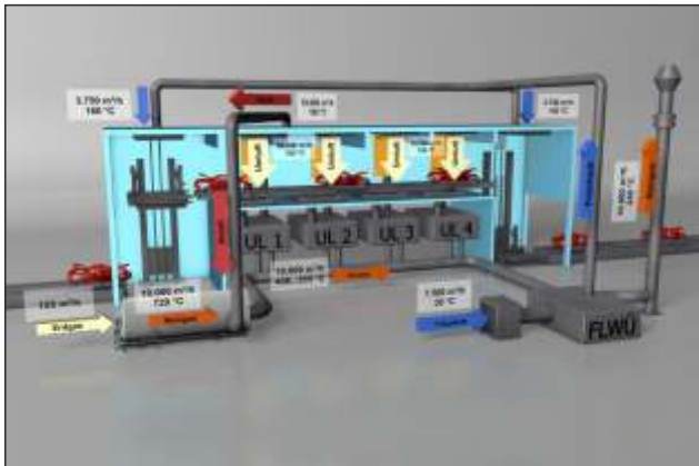
Bild 1: Lufthaushalt und Erdgasbedarf eines Decklackrockners ohne LAVA (Teillastbetrieb 70 %)
